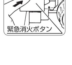
15 緊急消火ボタンを押して、対震自動消火装置を作動させ、しんが完全に下がることを2~3回確かめてください。
