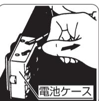
6 置台後部の電池ケースのつぎ目（2箇所）で、コードを手前に引き抜いてください。
