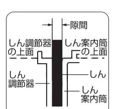
しん調節器の上面としん案内筒の上面（燃焼筒のる面）の高さが揃っていることを確認してください。（揃いが悪いと炎が片燃えします）
