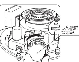
13 しん案内筒としん調節器の隙間が全周揃っている所で、1ページの6項ではずしたしん調節器の蝶ナット3本で均等に締めてください。一箇所のみを締め付けるのではなく、均等に徐々に締めてください。
