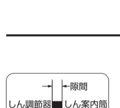
21 燃焼筒を、しん調節器の上へ正しくセットしてください。ガードを閉じて油タンクを入れてください。
