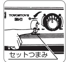
1 対震自動消火装置のセットつまみを押し下げて、対震自動消火装置を作動させてください。（作動しないと、ハグルマでけがをする場合があります）
