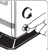
5 本体の両側面と背面にある体止めねじ（3箇所）をはずし、本体を取りはずしてください。
